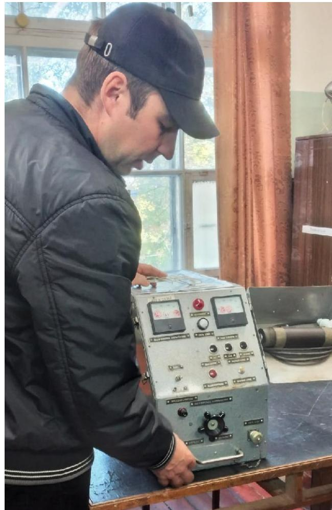
а также испытание изоляции кабеля.
